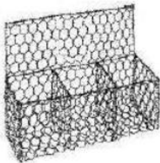
Fig. 7) Estructuras metálicas compuestas por mallas de alambre galvanizado de triple torsión formando paralelepípedos y rellenas con las piedras más cercanas a las obras.
